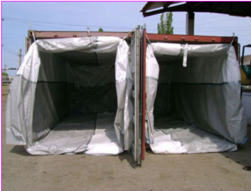
Рис 3. Контейнеры с установленными вкладышами.
