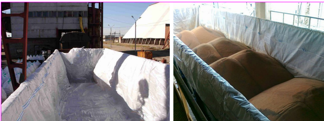
Рис 5. Прямая загрузка товарной продукции в полувагоны с ламинированным вкладышем.
