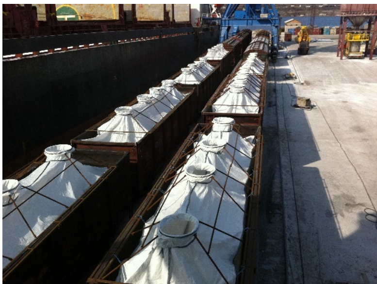
Рис 5. Прямая загрузка товарной продукции в полувагоны с ламинированным вкладышем.
